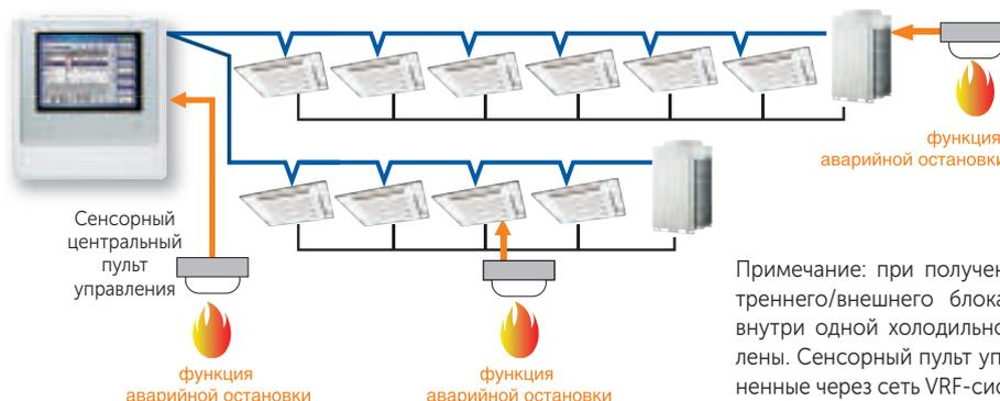
Примечание: при получении сигнала аварии от внутреннего/внешнего блока все блоки, соединенные внутри одной холодильной системы, будут остановлены. Сенсорный пульт управления: все блоки, соединенные через сеть VRF-системы, будут остановлены.
