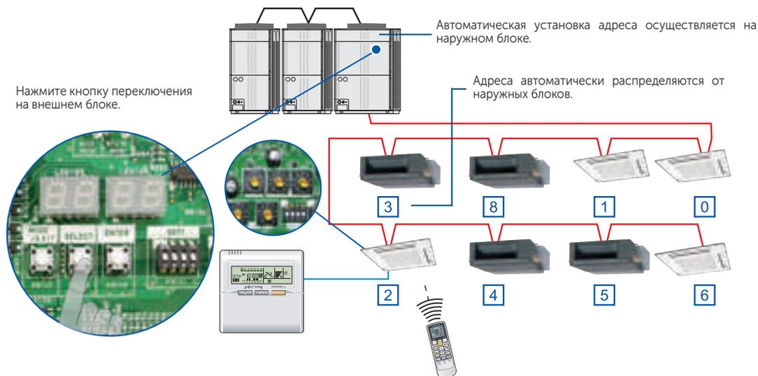
Ручная установка адреса внутреннего блока возможна также с помощью дистанционного пульта управления или дип-переключателей на плате внутреннего блока.
